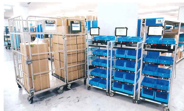
マルチピッキングカートシステムは、カートなども含めた高性能モデル「TWD-1100」(右)のほか、タブレット端末(TWD-900)と無線表示機(TWD-90)をセットにした「TWD-990」を用意。無線デジタル表示システムは、5色ボタンを備えた「TWD-120/150」(左)や廉価モデルの「TWD-100」が選べる
